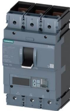
Interruttore 3VA2 IEC Frame 400 Classe del potere di interruzione M Icu=55kA @ 415V a 3 poli, protezione impianto ETU860, LSIG, In=400A protezione da sovraccarico Ir=160A...400A protezione da cortocircuito I<sub>sd</sub>=0,6..10x I<sub>n</sub>, I<sub>i</sub>=1,5..10x I<sub>n</sub> protezione del conduttore di neutro opzionale con trasformatore di corrente, fino a 160% protezione da guasto verso terra, disinseribile I<sub>g</sub>=0,2...1 x I<sub>n</sub>, tg=0,05-0,8s attacco piatto a vite
