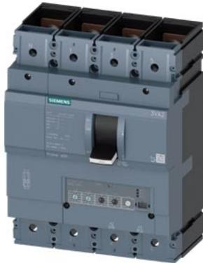
Interruttore 3VA2 IEC Frame 400 Classe del potere di interruzione M Icu=55kA @ 415V a 4 poli, protezione impianto ETU350, LSI, In=400A protezione da sovraccarico Ir=160A...400A protezione da cortocircuito I<sub>sd</sub>=1,5...10 x I<sub>r</sub>, I<sub>i</sub>=10 x I<sub>n</sub> protezione del conduttore di neutro impostabile (OFF, 50%, 100%) attacco piatto a vite
