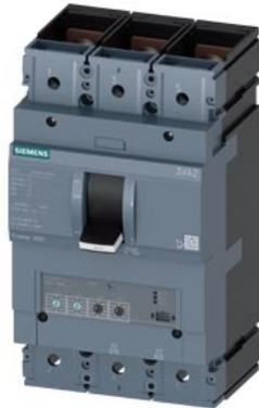
Interruttore 3VA2 IEC Frame 400 Classe del potere di interruzione M Icu=55kA @ 415V a 3 poli, protezione impianto ETU330, LIG, In=400A protezione da sovraccarico Ir=160A...400A protezione da cortocircuito li=1,5...10 x In protezione da guasto verso terra Ig=0,2...1 x In, tg=0,1/0,3s attacco piatto a vite
