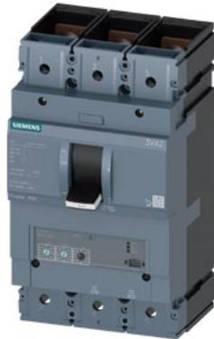
interruttore 3VA2 IEC frame 400 classe del potere di interruzione E Icu=200 kA @ 415 V a 3 poli, protezione impianto ETU320, LI, IN=400A protezione da sovraccarico Ir=160A ... 400A protezione da cortocircuito li=1,5 ... 12 x In attacco piatto a vite
