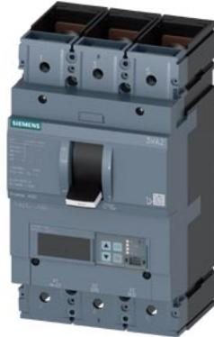
Interruttore 3VA2 IEC Frame 400 Classe del potere di interruzione L Icu=150kA @ 415V a 3 poli, protezione impianto ETU560, LSIG, In=250A protezione da sovraccarico Ir=100A...250A protezione da cortocircuito I<sub>sd</sub>=0,6..10x I<sub>n</sub>, I<sub>i</sub>=1,5..12x I<sub>n</sub> protezione del conduttore di neutro opzionale con trasformatore di corrente, fino a 160% protezione da guasto verso terra, disinseribile I<sub>g</sub>=0,2...1 x I<sub>n</sub>, tg=0,05-0,8s attacco piatto a vite
