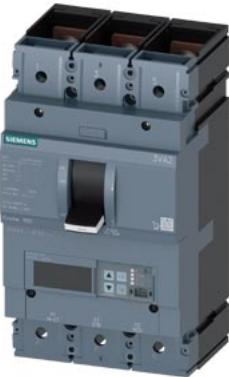
Interruttore 3VA2 IEC Frame 400 Classe del potere di interruzione L Icu=150kA @ 415V a 3 poli, protezione impianto ETU550, LSI, In=250A protezione da sovraccarico Ir=100A...250A protezione da cortocircuito Isd=0,6..10x In, li=1,5..12x In protezione del conduttore di neutro opzionale con trasformatore di corrente, fino a 160% attacco piatto a vite
