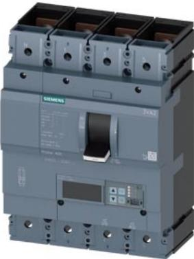
Interruttore 3VA2 IEC Frame 400 Classe del potere di interruzione C Icu=110kA @ 415V a 4 poli, protezione impianto ETU560, LSIG, In=250A protezione da sovraccarico Ir=100A...250A protezione da cortocircuito Isd=0,6..10x In, li=1,5..12x In protezione del conduttore di neutro impostabile (OFF, fino al 160%) protezione da guasto verso terra, disinseribile Ig=0,2...1 x In= tg=0,05-0,8s attacco piatto a vite
