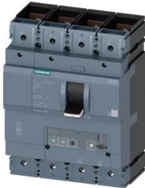
Interruttore 3VA2 IEC Frame 400 Classe del potere di interruzione C Icu=110kA @ 415V a 4 poli, protezione impianto ETU320, LI, In=250A protezione da sovraccarico Ir=100A...250A protezione da cortocircuito li=1,5...12 x In protezione del conduttore di neutro impostabile (OFF, 50%, 100%) attacco piatto a vite
