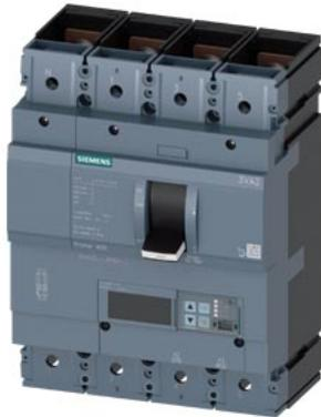
Interruttore 3VA2 IEC Frame 400 Classe del potere di interruzione H Icu=85kA @ 415V a 4 poli, protezione impianto ETU550, LSI, In=250A protezione da sovraccarico Ir=100A...250A protezione da cortocircuito I<sub>sd</sub>=0,6..10x I<sub>n</sub>, I<sub>i</sub>=1,5..12x I<sub>n</sub> protezione del conduttore di neutro impostabile (OFF, fino al 160%) attacco piatto a vite
