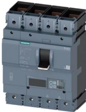
interruttore 3VA2 IEC frame 400 classe del potere di interruzione E Icu=200 kA @ 415 V a 4 poli, protezione impianto ETU860, LSIG, In=250A protezione da sovraccarico Ir=100 A ... 250 A protezione da cortocircuito I<sub>sd</sub>=0,6 ... 10 x I<sub>n</sub>, I<sub>i</sub>=1,5 ... 12xI<sub>n</sub> protezione del conduttore di neutro impostabile (OFF, fino a 100 %) attacco piatto a vite
