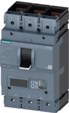
interruttore 3VA2 IEC frame 400 classe del potere di interruzione E Icu=200 kA @ 415 V a 3 poli, protezione impianto ETU850, LSI, In=250A protezione da sovraccarico Ir=100 A ... 250 A protezione da cortocircuito Isd=0,6 ... 10 x In, Ii=1,5 ... 12xIn attacco piatto a vite
