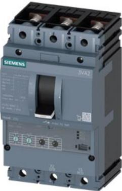
Interruttore 3VA2 IEC Frame 250 Classe del potere di interruzione L Icu=150kA @ 415V a 3 poli, protezione impianto ETU350, LSI, In=250A protezione da sovraccarico Ir=100A...250A protezione da cortocircuito Isd=1,5...10 x Ir, Ii=10 x In attacco piatto a vite
