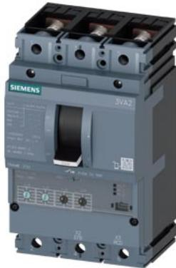
Interruttore 3VA2 IEC Frame 250 Classe del potere di interruzione L Icu=150kA @ 415V a 3 poli, protezione impianto ETU330, LIG, In=250A protezione da sovraccarico Ir=100A...250A protezione da cortocircuito li=1,5...10 x In protezione da guasto verso terra Ig=0,2...1 x In, tg=0,1/0,3s attacco piatto a vite
