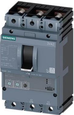
Interruttore 3VA2 IEC Frame 250 Classe del potere di interruzione L Icu=150kA @ 415V a 3 poli, protezione impianto ETU320, LI, In=250A protezione da sovraccarico Ir=100A...250A protezione da cortocircuito Ii=1,5...10 x In attacco piatto a vite
