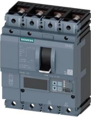
Interruttore 3VA2 IEC Frame 250 Classe del potere di interruzione C Icu=110kA @ 415V a 4 poli, protezione impianto ETU550, LSI, In=250A protezione da sovraccarico Ir=100A...250A protezione da cortocircuito Isd=0,6..10x In, li=1,5..10x In protezione del conduttore di neutro impostabile (OFF, fino a 100%) attacco piatto a vite
