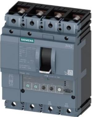
Interruttore 3VA2 IEC Frame 250 Classe del potere di interruzione C Icu=110kA @ 415V a 4 poli, protezione impianto ETU330, LIG, In=250A protezione da sovraccarico Ir=100A...250A protezione da cortocircuito Ii=1,5...10 x In protezione del conduttore di neutro impostabile (OFF, 50%, 100%) protezione da guasto verso terra Ig=0,2...1 x In= tg=0,1/0,3s attacco piatto a vite
