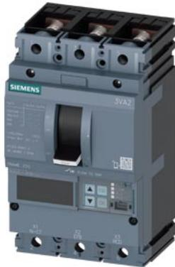
Interruttore 3VA2 IEC Frame 250 Classe del potere di interruzione M Icu=55kA @ 415V a 3 poli, protezione impianto ETU550, LSI, In=250A protezione da sovraccarico Ir=100A...250A protezione da cortocircuito I<sub>sd</sub>=0,6..10x I<sub>n</sub>, I<sub>i</sub>=1,5..10x I<sub>n</sub> protezione del conduttore di neutro opzionale con trasformatore di corrente, fino a 160% attacco piatto a vite
