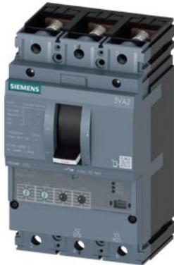
Interruttore automatico 3VA2 IEC Frame 250 Classe del potere di interruzione M Icu=55kA @ 415V a 3 poli, protezione impianto ETU350, LSI, In=250A protezione da sovraccarico Ir=100A...250A protezione da cortocircuito I<sub>sd</sub>=1,5...10 x I<sub>r</sub>, I<sub>li</sub>=10 x I<sub>n</sub> attacco piatto a vite
