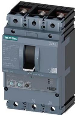
Interruttore automatico 3VA2 IEC Frame 250 Classe del potere di interruzione M Icu=55kA @ 415V a 3 poli, protezione impianto ETU320, LI, In=250A protezione da sovraccarico Ir=100A...250A protezione da cortocircuito Ii=1,5...10 x In attacco piatto a vite
