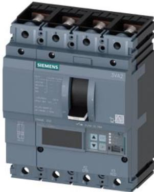
interruttore 3VA2 IEC frame 250 classe del potere di interruzione  $E_{Icu}=200 \text{ kA} @ 415 \text{ V}$  a 4 poli, protezione impianto ETU860, LSIG,  $I_n=250 \text{ A}$  protezione da sovraccarico  $I_r=100 \text{ A} \dots 250 \text{ A}$  protezione da cortocircuito  $I_{sd}=0,6 \dots 10 \times I_n$ ,  $I_{ll}=1,5 \dots 10 \times I_n$  protezione del conduttore di neutro impostabile (OFF, fino a 100 %) attacco piatto a vite
