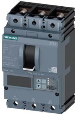
interruttore automatico 3VA2 IEC Frame 250 classe del potere di interruzione C Icu=110 kA con 415 V a 3 poli, protezione motore ETU550M, LSI, In=200 A protezione da sovraccarico Ir=80 A ... 200 A protezione da cortocircuito I<sub>sd</sub>=1,2... 15x I<sub>n</sub>, I<sub>li</sub>=3...15x I<sub>n</sub> attacchi piatti a vite
