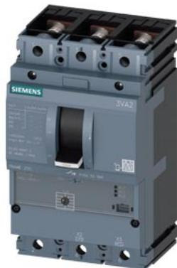
interruttore 3VA2 IEC frame 250 classe del potere di interruzione E Icu=200 kA @ 415 V a 3 poli, protezione avviatore motore ETU310M, I, In=160A protezione da cortocircuito li=3 ... 15 x In attacco piatto a vite
