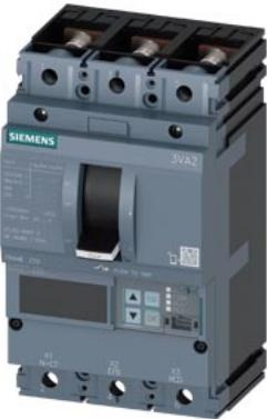
interruttore 3VA2 IEC frame 250 classe del potere di interruzione E Icu=200 kA @ 415 V a 3 poli, protezione motore ETU860M, LSIG, In=160A protezione da sovraccarico Ir=64A ... 160A protezione da cortocircuito Isd=1,2 ... 15xIn, li=3 ... 15xIn attacco piatto a vite
