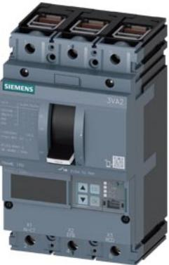
Interruttore automatico 3VA2 IEC Frame 160 Classe del potere di interruzione L Icu=150kA @ 415V a 3 poli, protezione impianto ETU560, LSIG, In=63A protezione da sovraccarico Ir=25A...63A protezione da cortocircuito Isd=0,6..10x In, li=1,5..12x In protezione del conduttore di neutro opzionale con trasformatore di corrente, fino a 160% protezione da guasto verso terra, disinseribile Ig=0,25...1 x In, tg=0,05-0,8s connessione a morsetto
