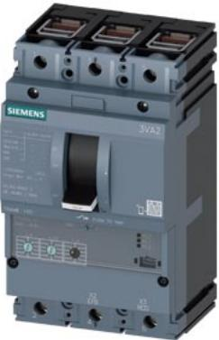
Interruttore automatico 3VA2 IEC Frame 160 Classe del potere di interruzione L Icu=150kA @ 415V a 3 poli, protezione impianto ETU320, LI, In=63A protezione da sovraccarico Ir=25A...63A protezione da cortocircuito Ii=1,5...12 x In connessione a morsetto
