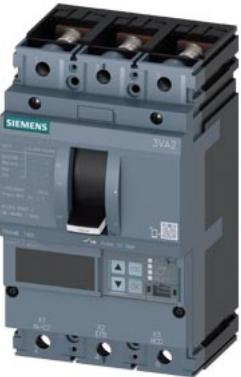
Interruttore automatico 3VA2 IEC Frame 160 Classe del potere di interruzione C Icu=110kA @ 415V a 3 poli, protezione motore ETU860M, LSIG, In=63A protezione da sovraccarico Ir=25A...63A protezione da cortocircuito Isd=1,2..15x In, li=3..15x In protezione da guasto verso terra, disinseribile Ig=0,25...1 x In, tg=0,05-0,8s attacco piatto a vite
