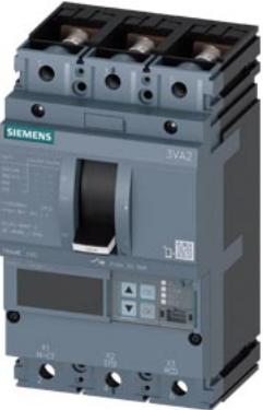
Interruttore automatico 3VA2 IEC Frame 160 Classe del potere di interruzione C Icu=110kA @ 415V a 3 poli, protezione impianto ETU850, LSI, In=63A protezione da sovraccarico Ir=25A...63A protezione da cortocircuito Isd=0,6..10x In, Ii=1,5..12x In protezione del conduttore di neutro opzionale con trasformatore di corrente, fino a 160% attacco piatto a vite
