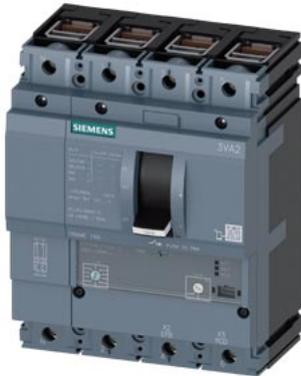
Interruttore automatico 3VA2 IEC Frame 160 Classe del potere di interruzione H Icu=85kA @ 415V a 4 poli, protezione impianto ETU340, ELISA LI, In=63A protezione da sovraccarico Ir=25A...63A protezione da cortocircuito Ii=15 x In protezione del conduttore di neutro impostabile (OFF, 100%) connessione a morsetto
