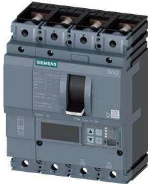
Interruttore automatico 3VA2 IEC Frame 160 classe del potere di interruzione M Icu=55kA @ 415V a 4 poli, protezione impianto ETU560, LSIG, In=63A protezione da sovraccarico Ir=25A...63A protezione da cortocircuito Isd=0,6..10x In, li=1,5..12x In protezione del conduttore di neutro impostabile (OFF, fino al 160%) protezione da guasto verso terra, disinseribile Ig=0,25...1 x In= tg=0,05-0,8s attacco piatto a vite
