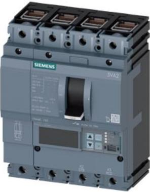
Interruttore automatico 3VA2 IEC Frame 160 Classe del potere di interruzione L Icu=150kA @ 415V a 4 poli, protezione impianto ETU860, LSIG, In=40A protezione da sovraccarico Ir=16A...40A protezione da cortocircuito lsd=0,6..10x In, li=1,5..12x In protezione del conduttore di neutro impostabile (OFF, fino al 160%) protezione da guasto verso terra, disinseribile lg=0,4...1 x In= tg=0,05-0,8s connessione a morsetto
