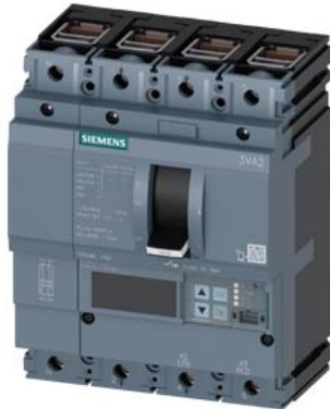
Interruttore automatico 3VA2 IEC Frame 160 Classe del potere di interruzione L Icu=150kA @ 415V a 4 poli, protezione impianto ETU850, LSI, In=40A protezione da sovraccarico Ir=16A...40A protezione da cortocircuito Isd=0,6..10x In, li=1,5..12x In protezione del conduttore di neutro impostabile (OFF, fino al 160%) connessione a morsetto
