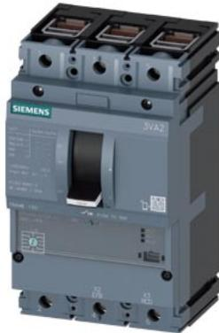
Interruttore automatico 3VA2 IEC Frame 160 Classe del potere di interruzione L Icu=150kA @ 415V a 3 poli, protezione impianto ETU340, ELISA LI, In=40A protezione da sovraccarico Ir=16A...40A protezione da cortocircuito Ii=15 x In connessione a morsetto
