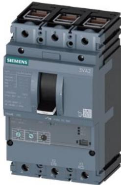
Interruttore automatico 3VA2 IEC Frame 160 Classe del potere di interruzione C Icu=110kA @ 415V a 3 poli, protezione motore ETU350M, LSI, In=40A protezione da sovraccarico Ir=16A...40A protezione da cortocircuito Isd=3...15 x Ir, li=15 x In connessione a morsetto
