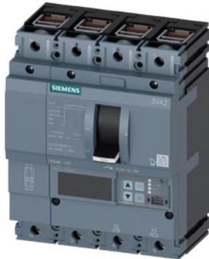
Interruttore automatico 3VA2 IEC Frame 160 Classe del potere di interruzione C Icu=110kA @ 415V a 4 poli, protezione impianto ETU860, LSIG, In=40A protezione da sovraccarico Ir=16A...40A protezione da cortocircuito I<sub>sd</sub>=0,6..10x I<sub>n</sub>, I<sub>i</sub>=1,5..12x I<sub>n</sub> protezione del conduttore di neutro impostabile (OFF, fino al 160%) protezione da guasto verso terra, disinseribile I<sub>g</sub>=0,4...1 x I<sub>n</sub>= tg=0,05-0,8s connessione a morsetto
