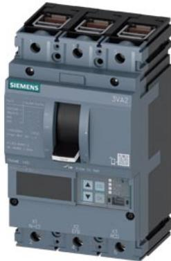
Interruttore automatico 3VA2 IEC Frame 160 Classe del potere di interruzione H Icu=85kA @ 415V a 3 poli, protezione impianto ETU550, LSI, In=40A protezione da sovraccarico Ir=16A...40A protezione da cortocircuito I<sub>sd</sub>=0,6..10x I<sub>n</sub>, I<sub>i</sub>=1,5..12x I<sub>n</sub> protezione del conduttore di neutro opzionale con trasformatore di corrente, fino a 160% connessione a morsetto
