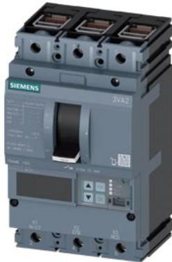
Interruttore automatico 3VA2 IEC Frame 160 classe del potere di interruzione M Icu=55kA @ 415V a 3 poli, protezione motore ETU860M, LSIG, In=40A protezione da sovraccarico Ir=16A...40A protezione da cortocircuito I<sub>sd</sub>=1,2..15x In, Ii=3..15x In protezione da guasto verso terra, disinseribile I<sub>g</sub>=0,4... 1 x In, tg=0,05-0,8s connessione a morsetto
