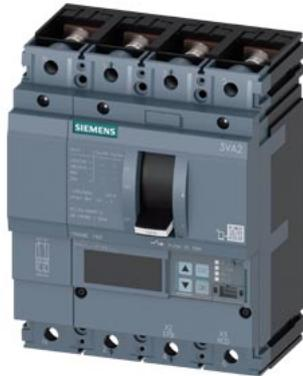
Interruttore automatico 3VA2 IEC Frame 160 classe del potere di interruzione M Icu=55kA @ 415V a 4 poli, protezione impianto ETU850, LSI, In=40A protezione da sovraccarico Ir=16A...40A protezione da cortocircuito Isd=0,6..10x In, li=1,5..12x In protezione del conduttore di neutro impostabile (OFF, fino al 160%) attacco piatto a vite
