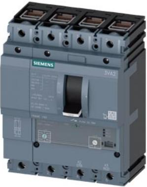
Interruttore automatico 3VA2 IEC Frame 160 classe del potere di interruzione M Icu=55kA @ 415V a 4 poli, protezione impianto ETU340, ELISA LI, In=40A protezione da sovraccarico Ir=16A...40A protezione da cortocircuito Ii=15 x In protezione del conduttore di neutro impostabile (OFF, 100%) connessione a morsetto
