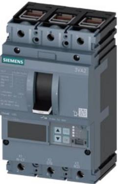
interruttore 3VA2 IEC frame 160 classe del potere di interruzione E Icu=200 kA @ 415 V a 3 poli, protezione impianto ETU860, LSIG, In=40A protezione da sovraccarico Ir=16 A ... 40A protezione da cortocircuito Icd=0,6 ... 10 x In, Ii=1,5 ... 12xIn connessione a morsetto
