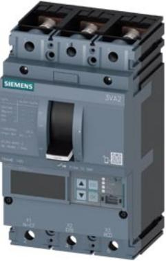
interruttore 3VA2 IEC frame 160 classe del potere di interruzione E Icu=200 kA @ 415 V a 3 poli, protezione impianto ETU860, LSIG, In=40A protezione da sovraccarico Ir=16 A ... 40A protezione da cortocircuito Isd=0,6 ... 10 x In, Ii=1,5 ... 12xIn attacco piatto a vite
