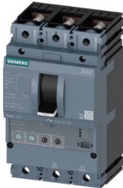
interruttore 3VA2 IEC frame 160 classe del potere di interruzione E Icu=200 kA @ 415 V a 3 poli, protezione impianto ETU350, LSI, In=40A protezione da sovraccarico Ir=16 A ... 40A protezione da cortocircuito Isd=1,5 ... 10xIr, li=12xIn attacco piatto a vite
