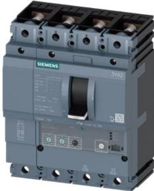
interruttore 3VA2 IEC frame 160 classe del potere di interruzione E Icu=200 kA @ 415 V a 4 poli, protezione impianto ETU320, LI, In=40A protezione da sovraccarico Ir=16 A ... 40A protezione da cortocircuito Ii=1,5 ... 12 x In protezione del conduttore di neutro impostabile (OFF, 100 %) attacco piatto a vite
