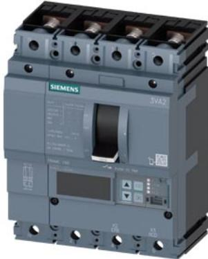
Interruttore automatico 3VA2 IEC Frame 160 Classe del potere di interruzione L Icu=150kA @ 415V a 4 poli, protezione impianto ETU860, LSIG, In=25A protezione da sovraccarico Ir=10A...25A protezione da cortocircuito I<sub>sd</sub>=0,6..10x I<sub>n</sub>, I<sub>i</sub>=1,5..12x I<sub>n</sub> protezione del conduttore di neutro impostabile (OFF, fino al 160%) protezione da guasto verso terra, disinseribile I<sub>g</sub>=0,2...1 x I<sub>n</sub>= tg=0,05-0,8s attacco piatto a vite
