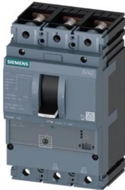
Interruttore automatico 3VA2 IEC Frame 160 Classe del potere di interruzione C Icu=110kA @ 415V a 3 poli, protezione avviatore ETU310M, I, In=25A senza protezione da sovraccarico protezione da cortocircuito li=3...15 x In attacco piatto a vite
