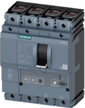
Interruttore automatico 3VA2 IEC Frame 160 Classe del potere di interruzione C Icu=110kA @ 415V a 4 poli, protezione impianto ETU320, LI, In=25A protezione da sovraccarico Ir=10A...25A protezione da cortocircuito Ii=1,5...12 x In protezione del conduttore di neutro impostabile (OFF, 100%) connessione a morsetto
