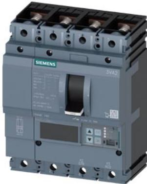
Interruttore automatico 3VA2 IEC Frame 160 Classe del potere di interruzione H Icu=85kA @ 415V a 4 poli, protezione impianto ETU560, LSIG, In=25A protezione da sovraccarico Ir=10A...25A protezione da cortocircuito Isd=0,6..10x In, li=1,5..12x In protezione del conduttore di neutro impostabile (OFF, fino al 160%) protezione da guasto verso terra, disinseribile Ig=0,2...1 x In= tg=0,05-0,8s attacco piatto a vite
