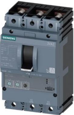
Interruttore automatico 3VA2 IEC Frame 160 Classe del potere di interruzione H Icu=85kA @ 415V a 3 poli, protezione impianto ETU320, LI, In=25A protezione da sovraccarico Ir=10A...25A protezione da cortocircuito Ii=1,5...12 x In attacco piatto a vite
