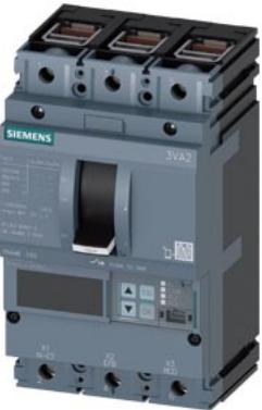
Interruttore automatico 3VA2 IEC Frame 160 classe del potere di interruzione M Icu=55kA @ 415V a 3 poli, protezione impianto ETU850, LSI, In=25A protezione da sovraccarico Ir=10A...25A protezione da cortocircuito Isd=0,6..10x In, Ii=1,5..12x In protezione del conduttore di neutro opzionale con trasformatore di corrente, fino a 160% connessione a morsetto
