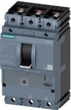
interruttore 3VA2 IEC frame 160 classe del potere di interruzione E Icu=200 kA @ 415 V a 3 poli, protezione avviatore motore ETU310M, I, In=25A protezione da cortocircuito Ii=3 ... 15 x In attacco piatto a vite
