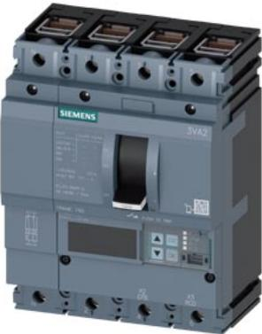
interruttore 3VA2 IEC frame 160 classe del potere di interruzione E Icu=200 kA @ 415 V a 4 poli, protezione impianto ETU850, LSI, In=25A protezione da sovraccarico Ir=10A ... 25A protezione da cortocircuito Isd=0,6 ... 10 x In, li=1,5 ... 12xIn protezione del conduttore di neutro impostabile (OFF, fino al 160 %) connessione a morsetto
